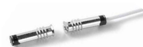
Die Magnetkontakte der MK-2000-Reihe haben ein selbstschneidendes Gewinde, das eine direkte bündige Montage in Holz- oder Kunststoffmaterialien ohne Zubehör gestattet.
