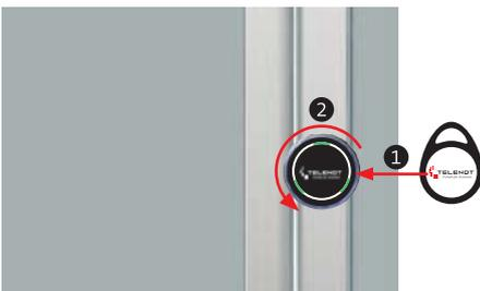
Das elektronische Knaufmodul ist im Ruhezustand nicht in den Schließnocken des Zylindergehäuses eingekoppelt, d. h. Sie können den Knauf leer durchdrehen. Dabei signalisieren drei rote LEDs für ca. 3 s, dass keine Freigabe vorhanden ist. Wird ein eingelernter Transponder vor die RFID-Leseeinheit des elektronischen Knaufmoduls gehalten, signalisieren eine rote und eine grüne Leuchtdiode die Freigabe der Bedienung. Gleichzeitig koppelt der Knauf in den Schließnocken des Zylindergehäuses ein.
