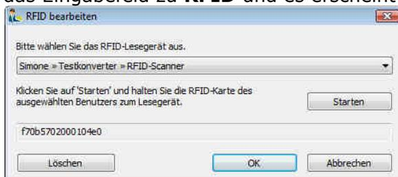
Wählen Sie nun das RFID-Lesegerät (ist ein im System ekey net konfigurierter ekey net Fingerscanner RFID) aus, über den Sie die Kartenummer einlesen möchten und klicken Sie auf „**Start**“. Nehmen Sie die RFID-Karte, welche Sie dem Benutzer zuweisen möchten, und halten Sie diese vor das ausgewählte Lesegerät. Die Kartenummer wird nun gelesen und im Datenfeld eingetragen. Anschließend klicken Sie „**OK**“. Dem Benutzer ist nun die Kartenummer zugewiesen.
